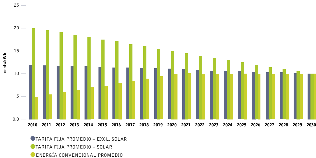
figura 2.2: tarifa fija versus la generación de energía convencional
